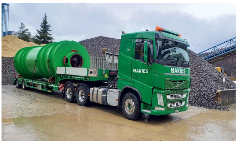
Die neue Kieswaschtrommel vor dem Einbau auf dem MAKIES-Tiefgänger.
